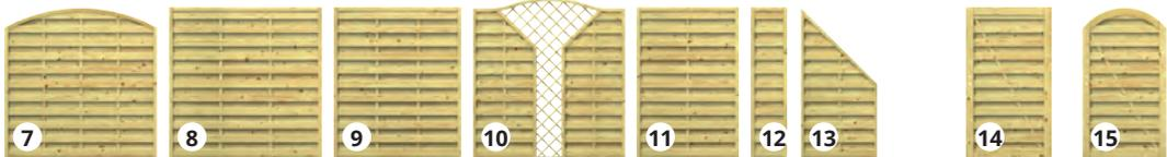
**LETTLAND**, Nadelholz (kdi), Rahmen aus Kiefer, Zaunrahmen 42 x 42 mm, Torrahmen 44 x 88 mm, Lamellen aus Fichte, 8 x 92 mm, fein gerillt, mit Dekorfäden, Rahmenecken verzapft
